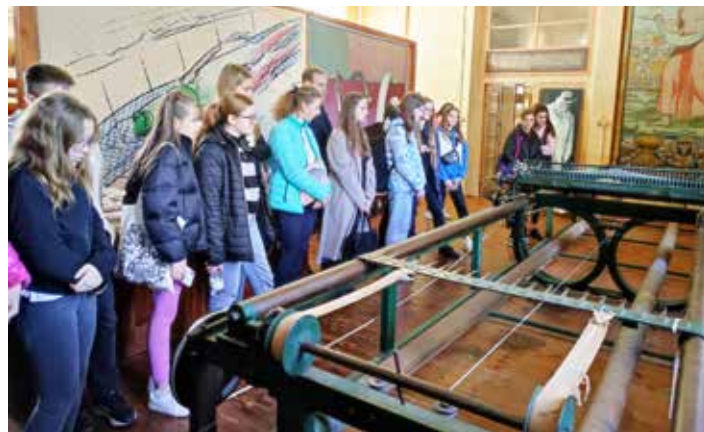
Stroj na zastřížení gobelínů. Je z roku 1908, je jednoduchý, bezporuchový a stále ho v gobelince používají
